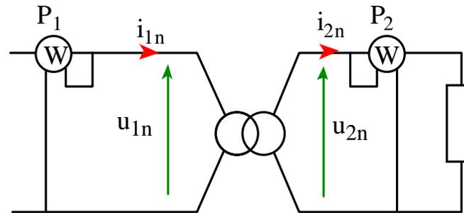
Cette méthode ne permet pas d'avoir une bonne précision sur la détermination du rendement du fait que  $95\% < \eta < 99\%$ . On préfère souvent utiliser la méthode des pertes séparées.
