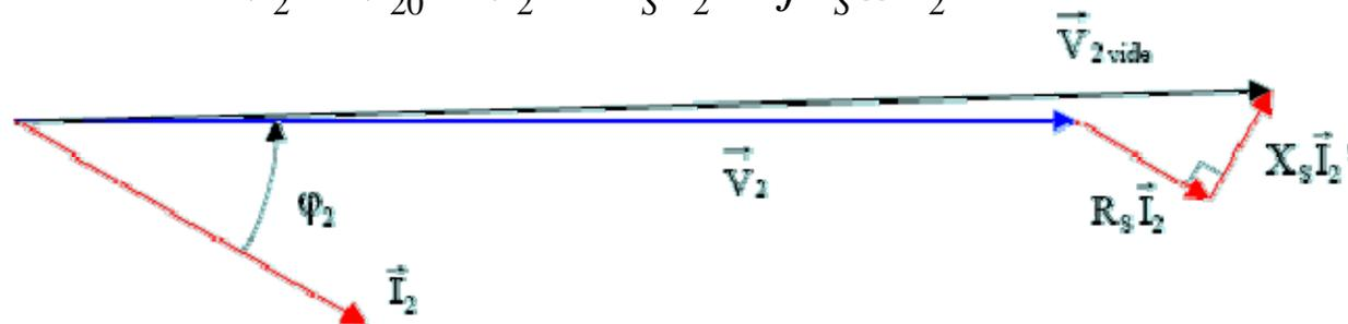
En pratique :  $R_S I_2$  et  $L_S \omega I_2 \ll V_2$
