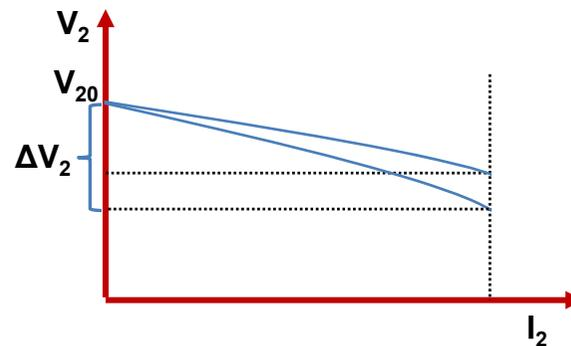
La différence  $\Delta V_2$  entre la tension à vide  $V_{20}$  et la tension  $V_2$  en charge s'appelle **la chute de tension** au secondaire du transformateur. Elle dépend de la nature de la charge.
